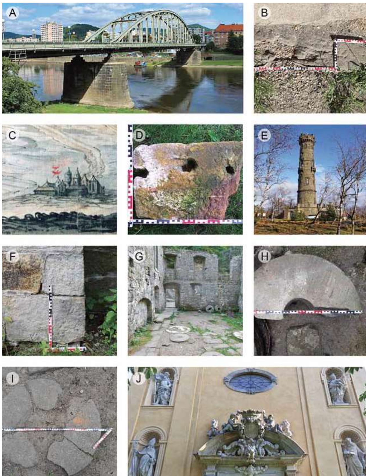
2/2) Lokalizace odběru stavebního kamene na historických stavbách. A – Tyršův most v Děčíně od jihozápadu; B – vzorek D6 odebrán z opadu základového soklu východního pilíře; C – zámecký areál Schönstein v Tisě od jihozápadu na mapě panství z roku 1629; D – vzorek D7 odebrán z architektonického článku nalezeném na parcele č. 693/2; E – Rozhledna na Děčínském Sněžníku v pohledu od západu; F – vzorek D8 odebrán z opadu armování východní zdi podnože rozhledny; G – interiér mlýnice Dolského mlýna v pohledu k západu, druhotně umístěním mlecích kamenů; H – vzorek D9 odebrán ze zlomku běhouny; I – vzorek D10 odebrán ze zlomku smletého ležáku; J – Hlavní průčelí kostela sv. Antonína Paduánského v Milešově. Vzorek D11 pochází z opadu zvětralého povrchu sochy sv. Ludmily, která je umístěna v pravé horní nise. Foto K. Podroužek.
